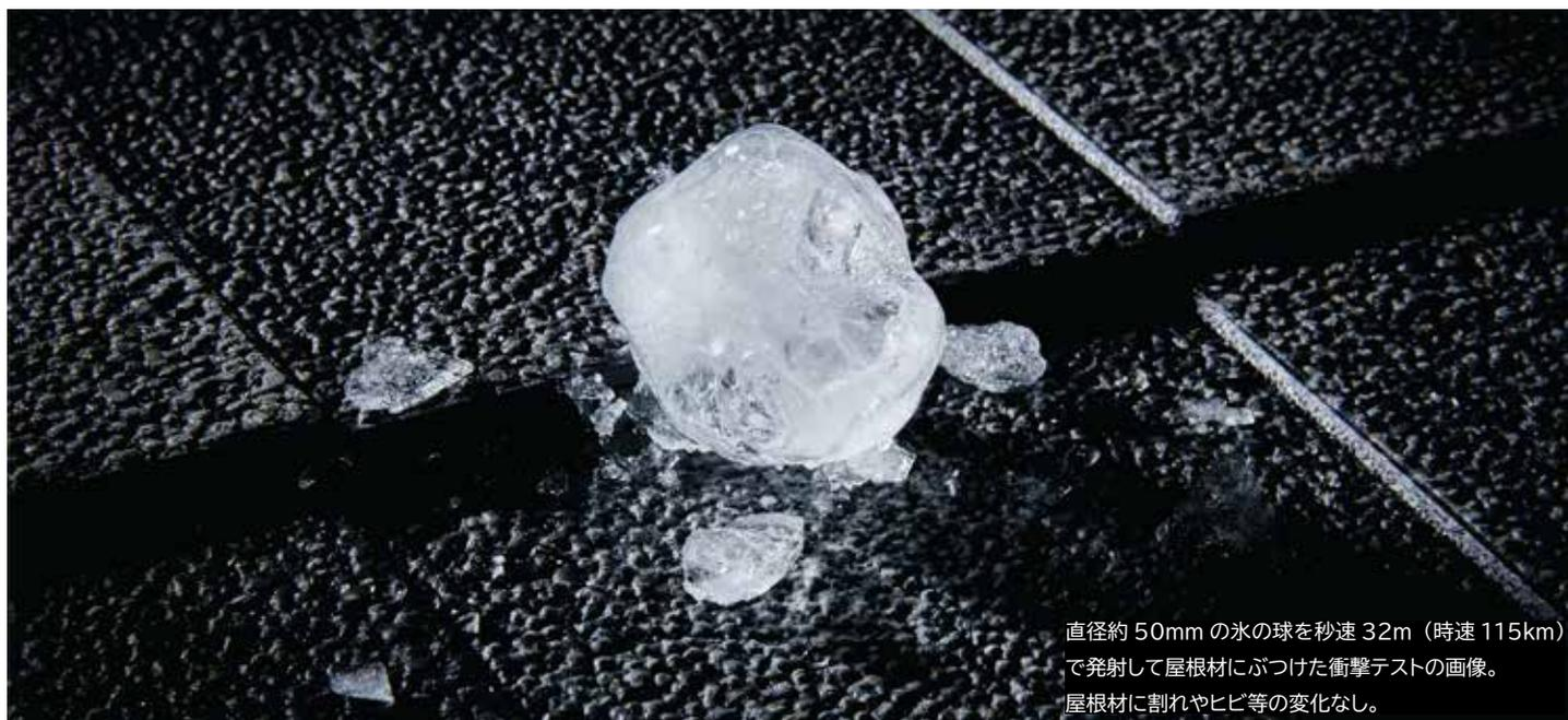
直径約 50mm の水の球を秒速 32m (時速 115km) で発射して屋根材につづけた衝撃テストの画像。
